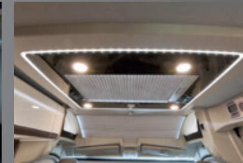
Baldachin mit indirekter Beleuchtung und zusätzlichen LEDs sorgt für optimale Ausleuchtung in der Sitzgruppe.
